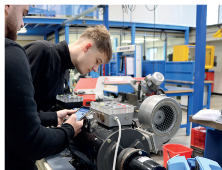
Alignement de l'arbre moteur
